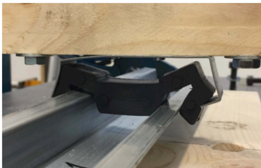
Figur 5. Typisk deformasjon ved maksimalbelastning, horisontal montering og uttrekk (tak/himling).
