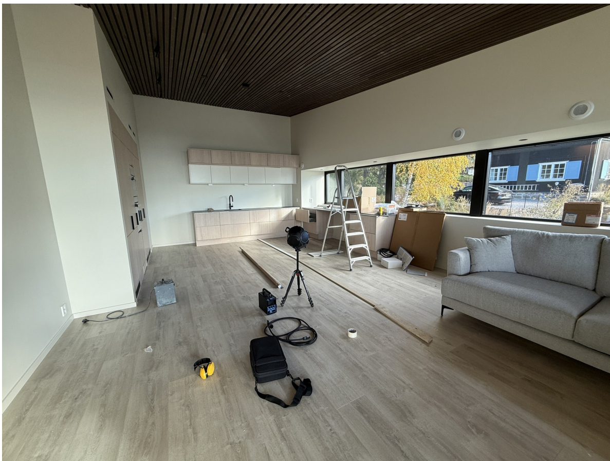
Stue/kjøkkenen i hovedboligen med måleutstyr. Rommet er mottakerrom ved luftlydmålingen.
