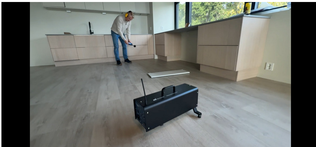
Standardisert trinnlydmaskin i stue/kjøkken under målingen.
